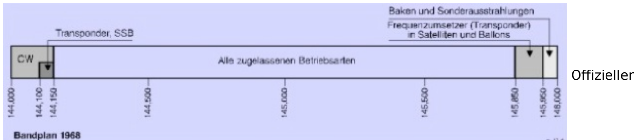
Bandplan für das 2 Meter Band 1968
