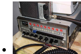
Yaesu FT-2 AUTO, 1972 der Nachfolger des FT-2 mit acht Quarzkanälen, Priority- und Scanfunktion!
