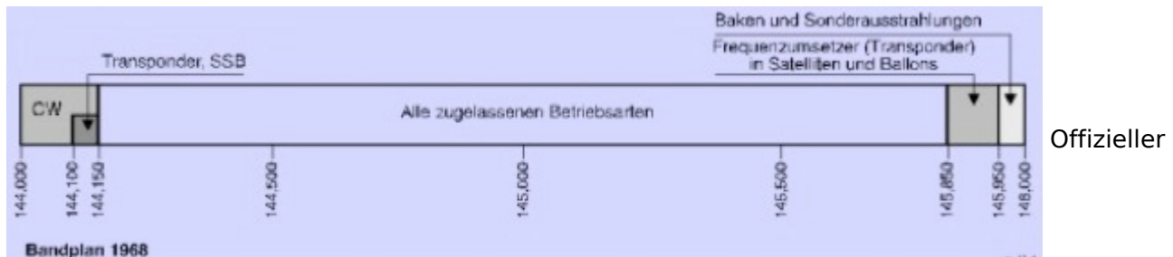
Bandplan für das 2 Meter Band 1968
