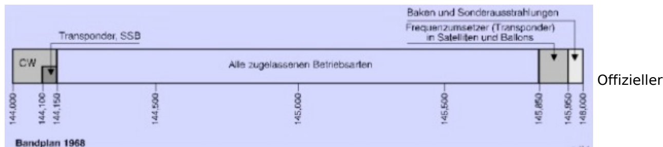
Bandplan für das 2 Meter Band 1968
