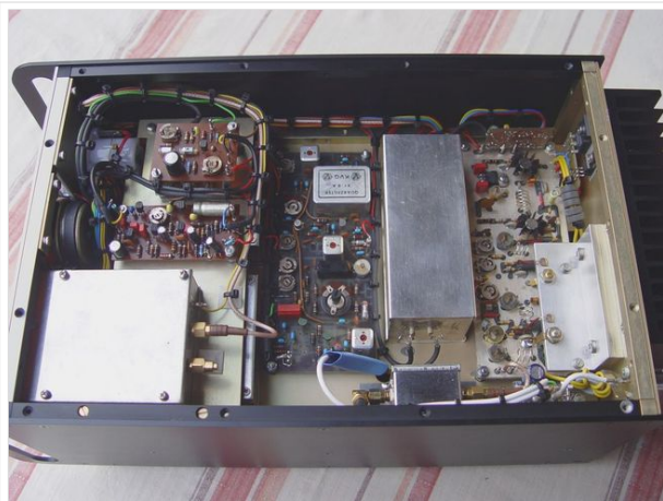
Neukonstruktion des SSB/FM-2m-Transceivers aus SEMCO-Bausteinen
