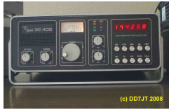
Tischgerät SE 402, FM, SSB, CW; Pout: 10 W (1977)
