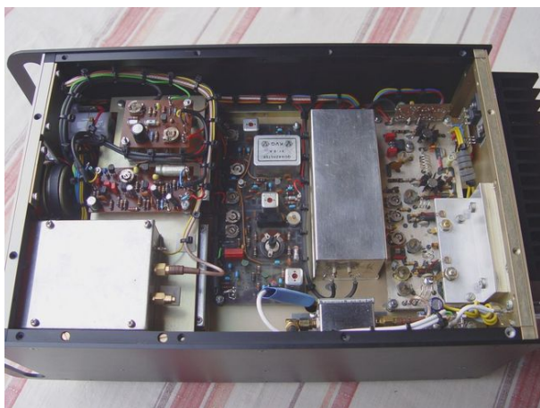
Neukonstruktion des SSB/FM-2m- Transceivers aus SEMCO-Bausteinen
