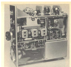
Bild 88. Innenansicht der 2m-Station von DL 9 AL mit Zf-Baustein
