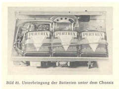
Bild 81. Unterbringung der Batterien unter dem Chassis
