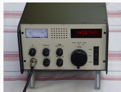
Neukonstruktion DK4SX, mit Umschalter FM/SSB und Relaisablage
