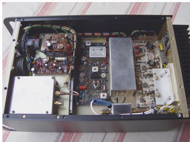
Neukonstruktion des SSB/FM-2m-Transceivers aus SEMCO-Bausteinen
