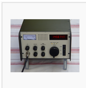
Neukonstruktion DK4SX, mit Umschalter FM/SSB und Relaisablage
