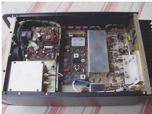
Neukonstruktion des SSB/FM-2m-Transceivers aus SEMCO-Bausteinen
