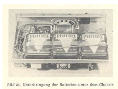
Unterbringung der Batterien unter dem Chassis DJ5MM
