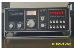
Tischgerät SE 402, FM, SSB, CW; Pout: 10 W (1977)
