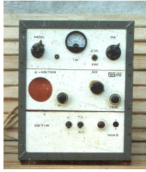
2m AM/FM Sender /Empfänger mit QQE03 /12 und EL34 im Modulator, OE7IW
