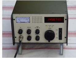
Neukonstruktion DK4SX, mit Umschalter FM/SSB und Relaisablage
