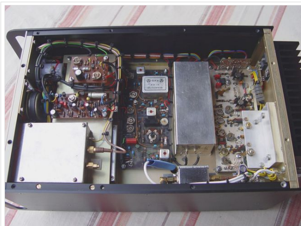
Neukonstruktion des SSB/FM-2m-Transceivers aus SEMCO-Bausteinen
