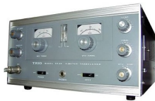
Trio TR-2E, 10W AM Transceiver aus dem Jahr 1967
