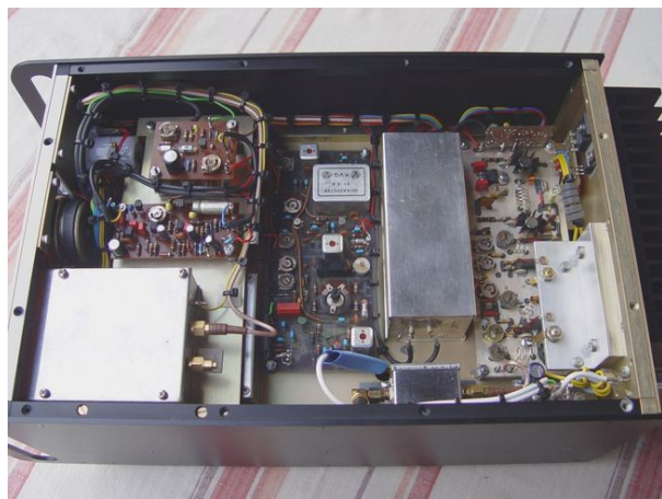
Neukonstruktion des SSB/FM-2m- Transceivers aus SEMCO-Bausteinen
