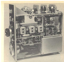
Bild 64. Innenansicht der 2-m-Station von DL9AL mit Zf-Baustein
