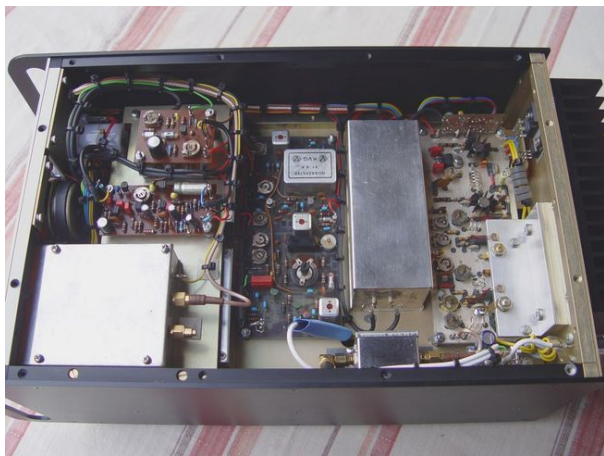
Neukonstruktion des SSB/FM-2m- Transceivers aus SEMCO-Bausteinen
