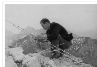
Zusammenbau der Langyagi am Berg
