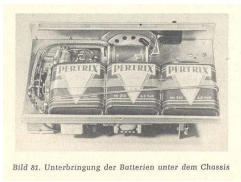
Unterbringung der Batterien unter dem Chassis DJ5MM
