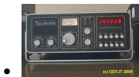
Tischgerät SE 402, FM, SSB, CW; Pout: 10 W (1977)
