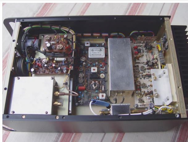
Neukonstruktion des SSB/FM-2m-Transceivers aus SEMCO-Bausteinen
