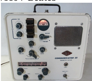
Der Gonset GC-105 "Gooney Bird" Communicator ist ein AM Transceiver für 12 /110V Betrieb
