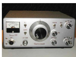
Originales SEMCO- SSB, getrennte FM /SSB Einstellung für TX und RX, BFO- Abstimmung
