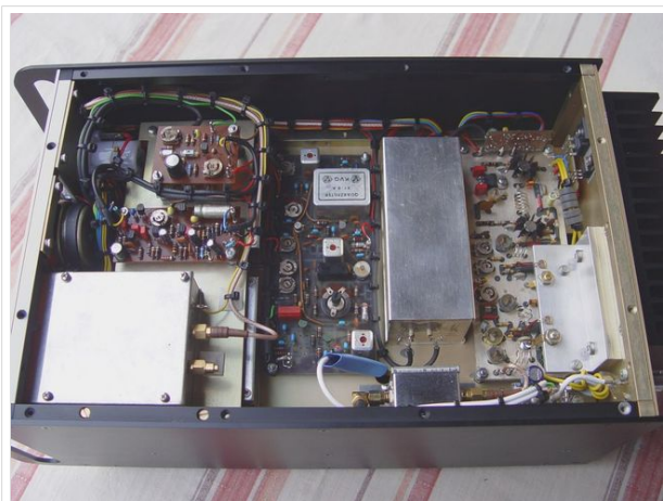
Neukonstruktion des SSB/FM-2m-Transceivers aus SEMCO-Bausteinen
