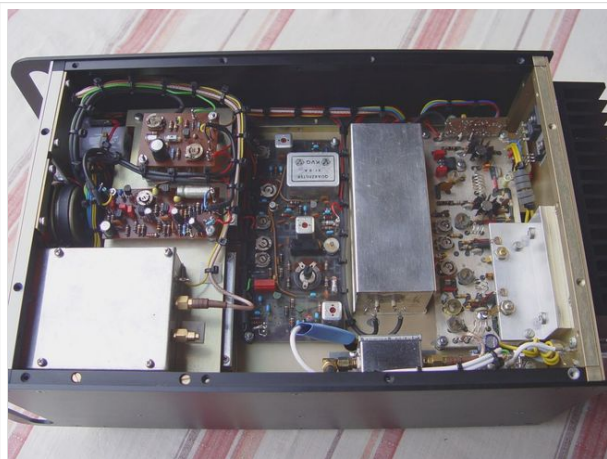
Neukonstruktion des SSB/FM-2m-Transceivers aus SEMCO-Bausteinen
