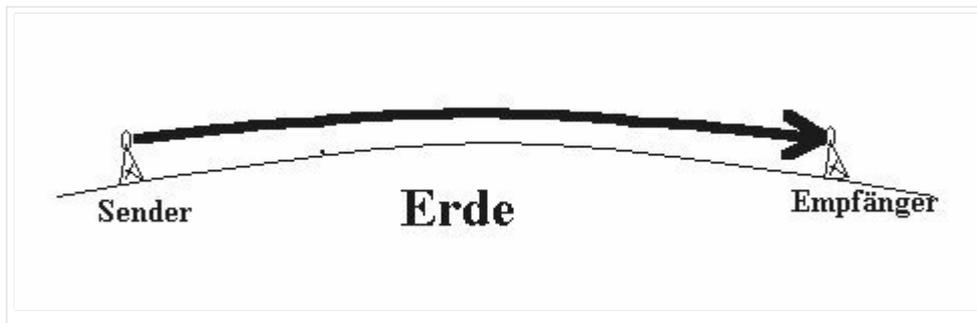
Diesen Ausbreitungsweg, bei dem die Wellen quasi parallel zum Erdboden laufen, nennt man Bodenwellenausbreitung, oder kurz 'Bodenwelle'.
