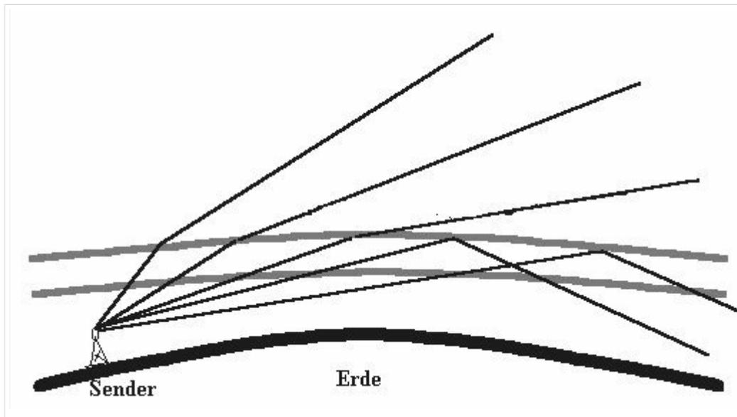
Bei extrem günstigen Bedingungen (maximale Ionisation, flachster möglicher Winkel) ist die Grenzfrequenz der Ionosphäre 30 MHz. Alle höherfrequenten Wellen werden ohne Ausnahme in den Weltraum durchgelassen.
