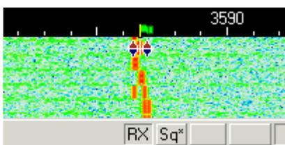
Die TX- und RX-Frequenzen zeigen die Werte aus dem Wasserfall. Ich empfehle Werte um 1500 Hz in der Mitte des Paßbandes.
