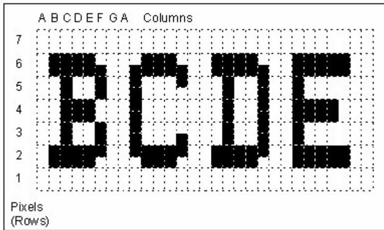
werden leere (weiße) Punkte eingefügt. Wenn Sie die Gesamtpunktzahl mit den gesendeten schwarzen Punkten vergleichen, kommen Sie auf einen Lastfaktor von etwa 22%. Das Verhältnis Spitze zu Durchschnitt ist hoch, so daß auch unter gestörten Bedingungen eine gute Lesbarkeit erreicht wird.
