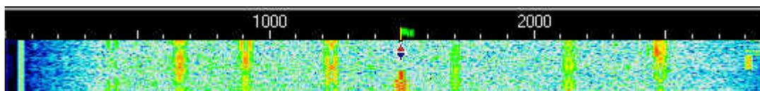
**Leistung:** Wegen der geringen Bandbreite des Signals können Sie mit kleiner Leistung funken. PSK31 eignet sich vorzüglich für QRP-Betrieb. Sie können DX mit einem Watt arbeiten. Der Einsatz von großen Leistungen bei PSK31 ist eine schlechte Praxis.
