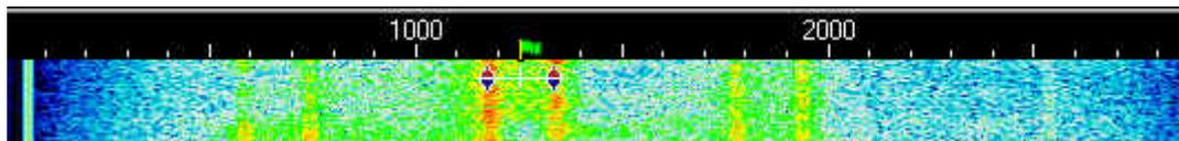
Sie sehen im Wasserfall drei RTTY-Signale, die Sie mit einem einfachen linken Mausklick anwählen können. Das stärkste liegt in der Mitte und wird sich zu 100% mitschreiben lassen, bei den beiden anderen müssen Sie mit Fehlern rechnen.
