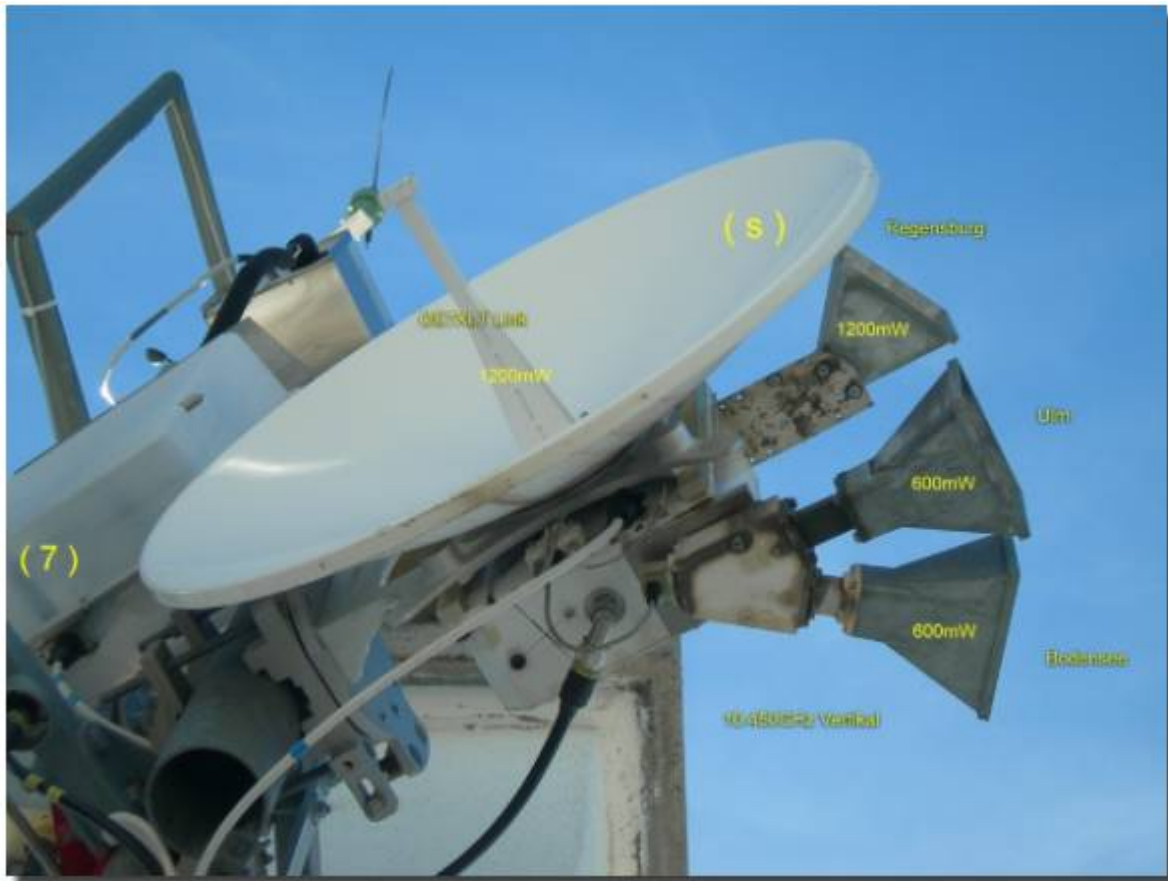
Sendeseitig: 4 Stück Hornstrahler und ein Primärfokus Spiegel ( S )
