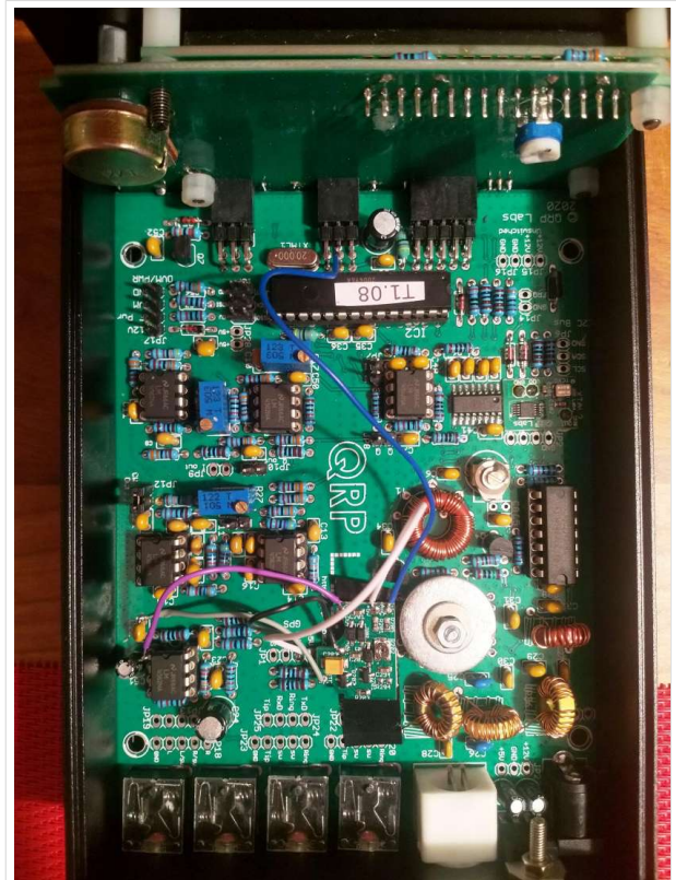
QCX+ mit eingebautem AGC Kit von grp-labs mit Firmware Update 1.08. Das Kit basiert auf dem Schaltungsentwurf von Jim AJ8S
