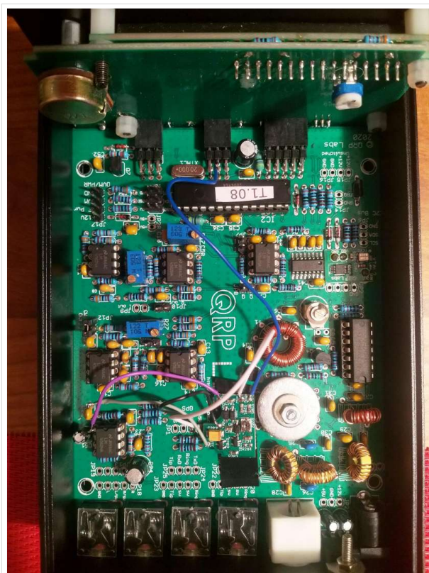
QCX+ mit eingebautem AGC Bausatz von grp-labs mit Firmware Update 1.08. Der Bausatz basiert auf dem Schaltungsentwurf von Jim AJ8S
