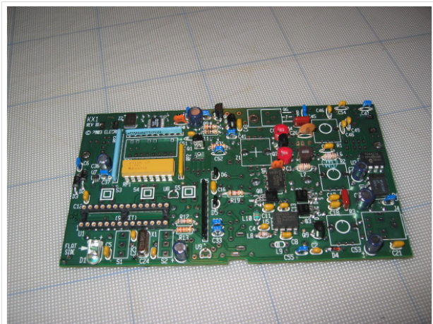
Hauptplatine mit alle flachen Teilen
