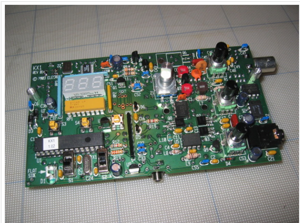
HProzessor und RX komplett; bereit für ersten Test
