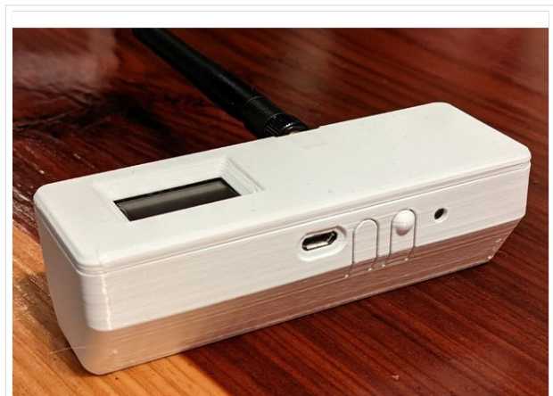
TBEAM Gehäuse mit Tasten und OLED
