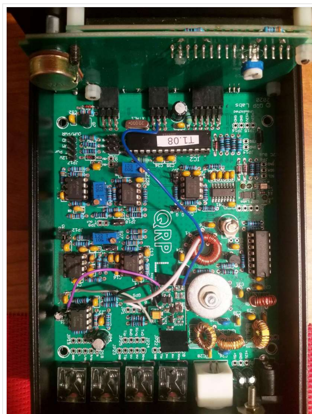
QCX+ mit eingebautem AGC Bausatz von grp-labs mit Firmware Update 1.08. Der Bausatz basiert auf dem Schaltungsentwurf von Jim AJ85
