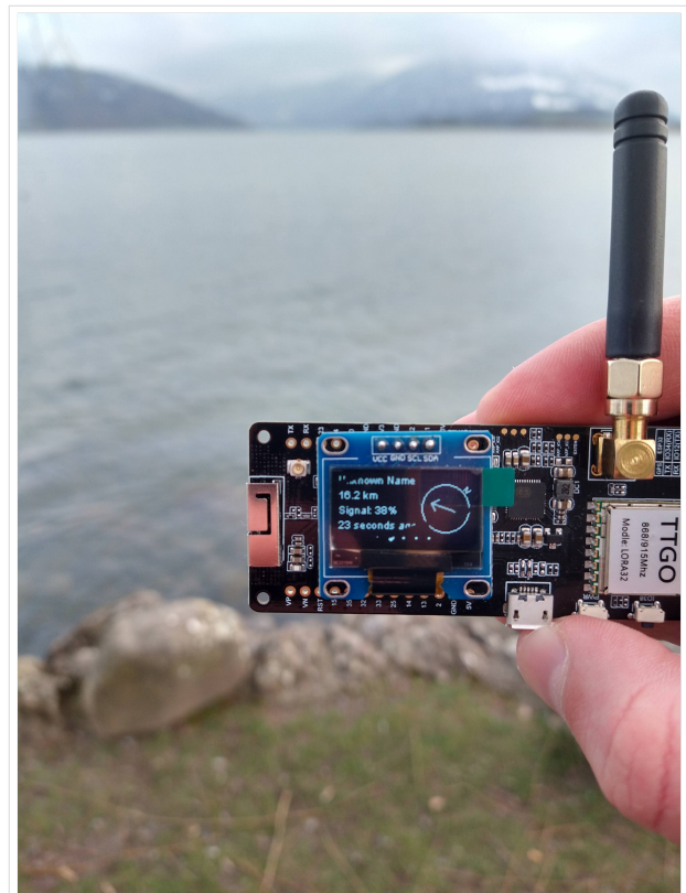
TBEAM Lora mit OLED-Display
