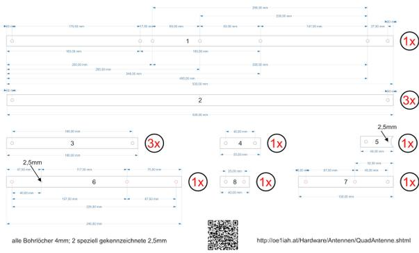
Aluminium Teile und Bohrplan
