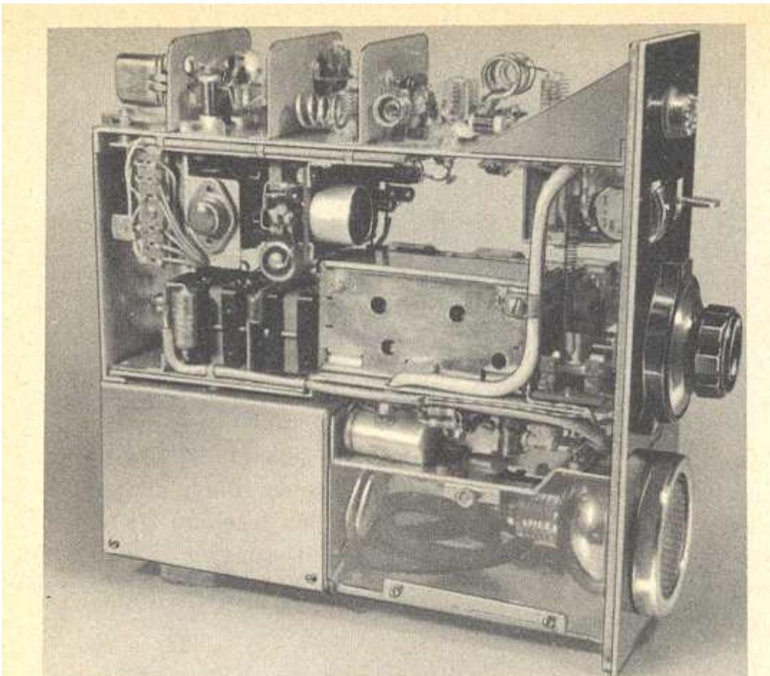
*Bild 87. 2-m-Station von DL 9 AL. Innenansicht von der Tuner-Seite*
