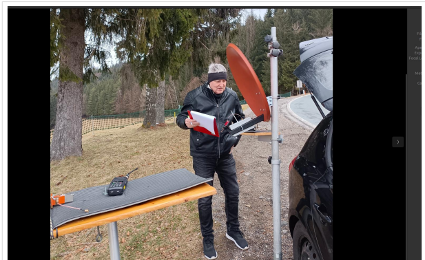
OE8FNK beim Aktivitätskontest am 18.2.2024, QRV auf 70cm (Handfunkgerät links), und El Cuatro mit Vivaldi Antenne im Feed des Offsetspiegels für 23cm, 13cm, 9cm und 6cm.
