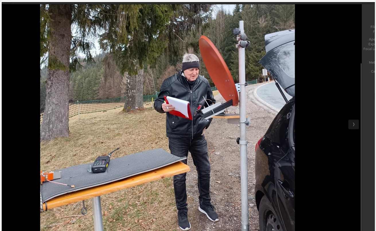
8 Jahre El Cuatro: OE8FNK beim Aktivitätskontest am 18.2.2024, QRV auf 70cm (Handfunkgerät links), und El Cuatro mit Vivaldi Antenne im Feed des Offsetsiegels für 23cm, 13cm, 9cm und 6cm.
