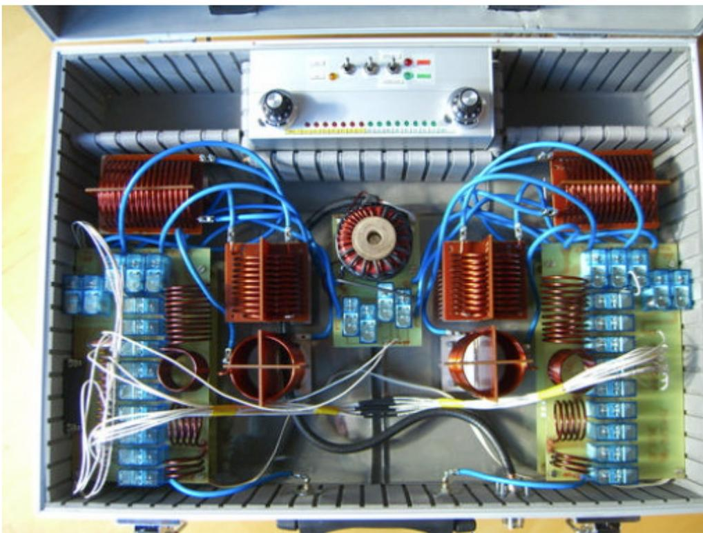
„Kabelgewirr“ wird demnächst durch kurze Direkt Verbindungen ersetzt. In der Quelle von DC4JG sieht man das auf den Fotos recht gut wie es sein sollte. Also dieses Detail besser nicht von dem Foto unten kopieren.
