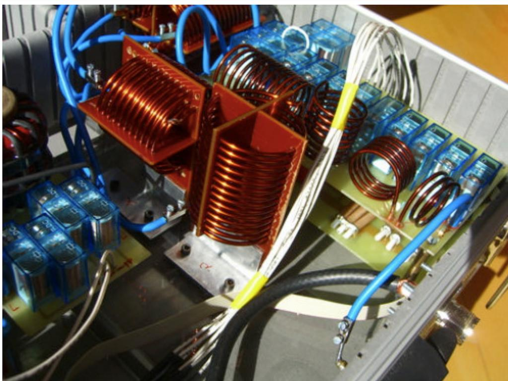
L/C Modul rechts mit Steuerstrang Verbindung zur linker Seite (weiße Kabel). Der CSteuerstrang wurde mit Flachbandkabel hergestellt (am Boden verlegt). Rechts im Bild die PL Buchse zum Anschluss an Transceiver bzw. PA.
