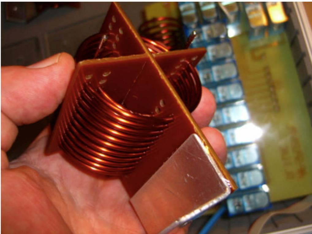
Montagewinkel (geklebt). Es hat sich gezeigt dass ein Bohrungsdurchmesser 2.5mm ideal für die Einbringung des Drahtes ist und der Spule trotzdem keine Raum zum Wackeln lässt.
