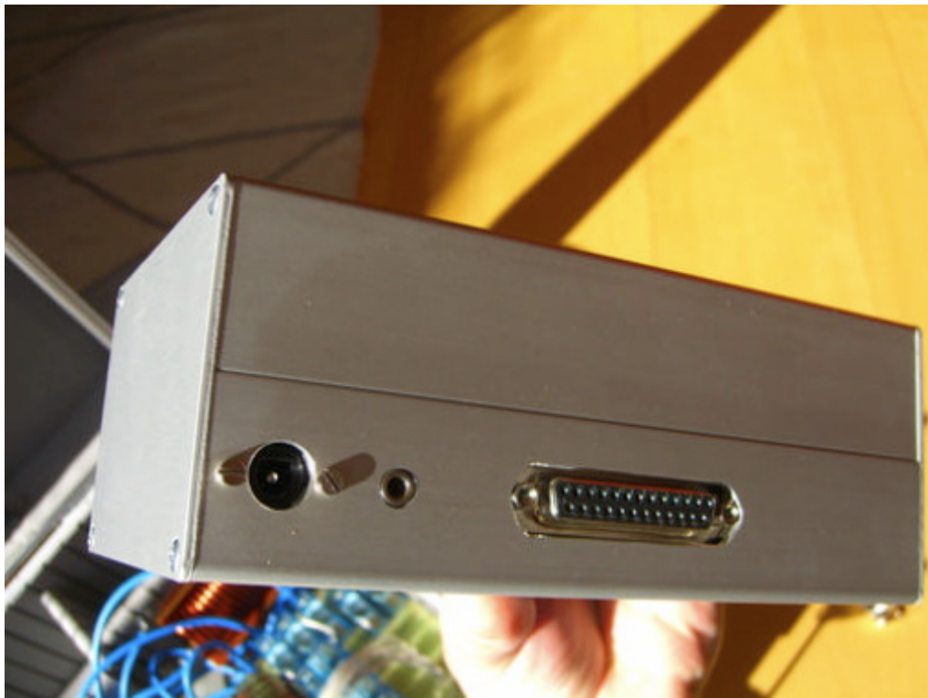
Rückseite, Buchsen von Links nach Rechts: 12V DC – PA Verriegelung - Koppler
