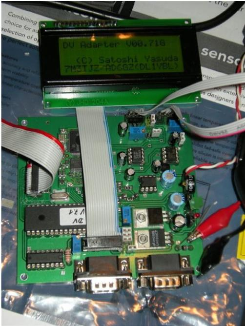
Der DV-Adapter, wie er als Bausatz beim Funkamateur angeboten wurde (neue Version wird in Kürze angeboten werden) Der DV-Adapter ermöglicht DSTAR Betrieb mit vielen 9600Baud-fähigen Funkgeräten.
