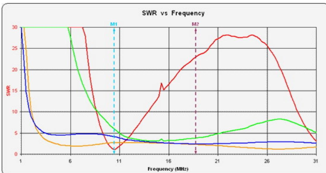
Die Graphik zeigt das VSWR gemessen an der Basis eines 6,5m hohen Vertikaltrahler getragen durch eine 10m Angelrute.
