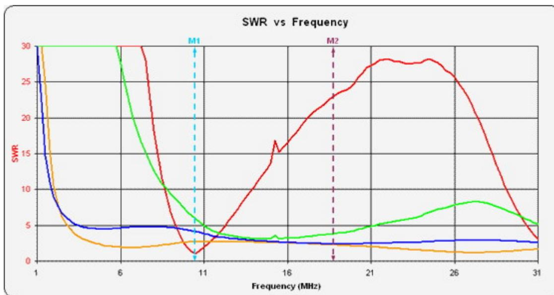
Die Graphik zeigt das VSWR gemessen an der Basis eines 6,5m hohen Vertikalstrahlers getragen durch eine 10m Angelrute.
