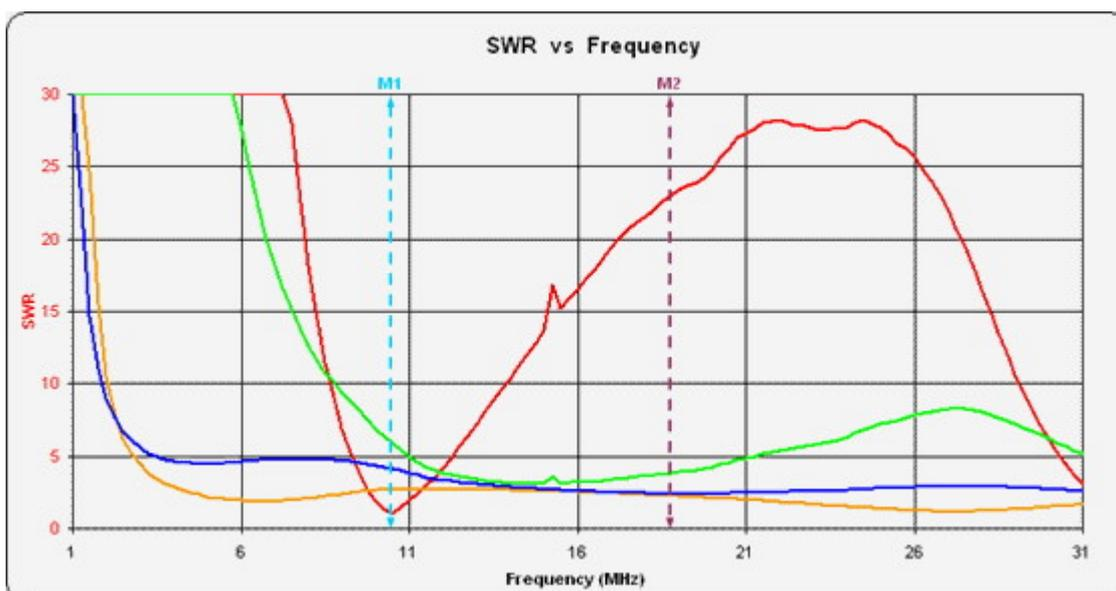
Die Graphik zeigt das VSWR gemessen an der Basis eines 6,5m hohen Vertikalstrahler getragen durch eine 10m Angelrute.
