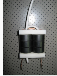
OE1IFM Aufbau Transformator
