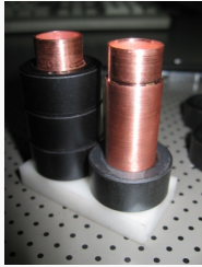
OE1IFM Aufbau Transformator
