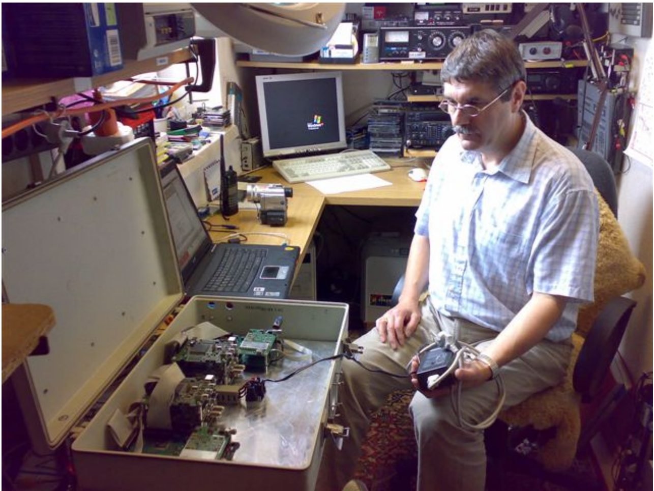
Der neu aufgebaute Digitale Linksender
