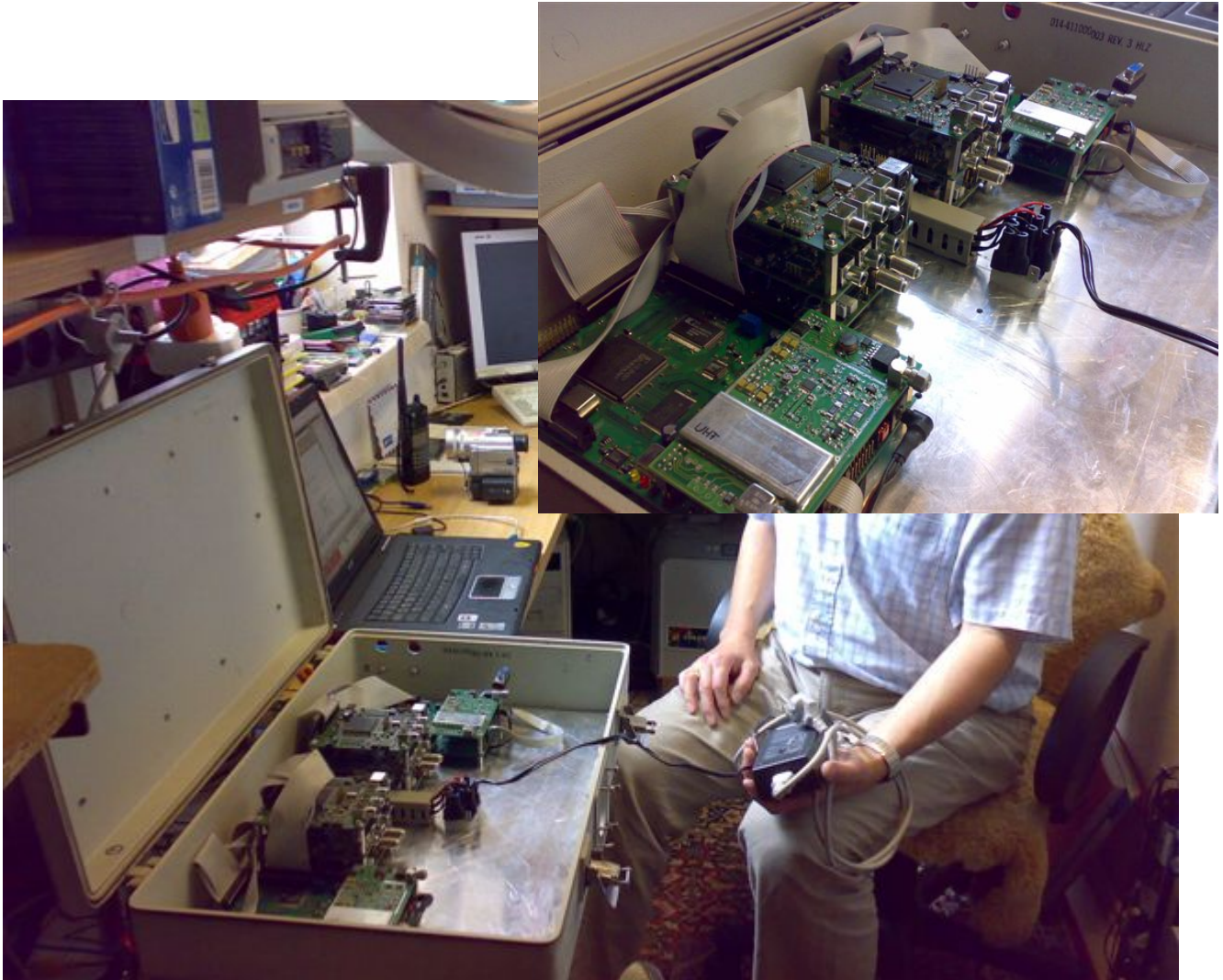
Der neu aufgebaute Digitale Linksender
