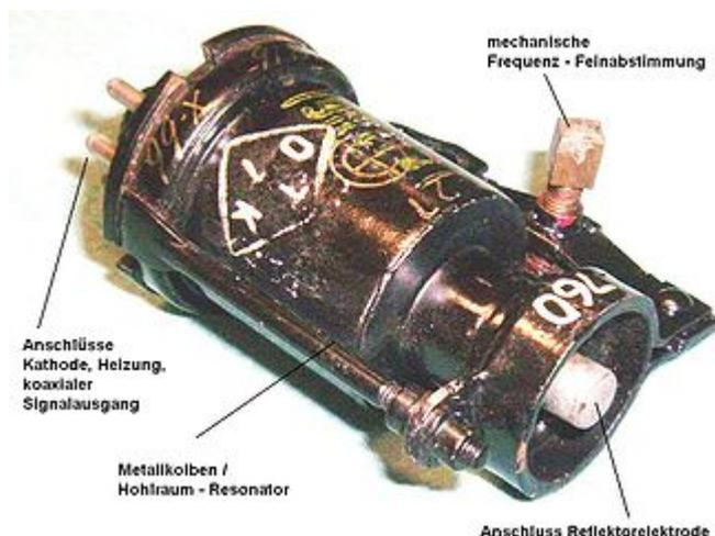
Aus diesen Anfängen und Frühzeit der Amateur Mikrowellentechnik finden wir heute nur mehr wenige Applikationen und Berichte aus dem Angloamerikanischen Raum. Als Frequenzbestimmendes Element diente ein auf der passenden Frequenz abgestimmter Hohlraumresonator. Bevorzugt verwendet wurde das Reflexklystron vom Typ 723A/B, dass ursprünglich für den Frequenzbereich von 9,5GHz entwickelt und von den Funkamateuren für den Betrieb im 3cm Amateurfunkband für einen
