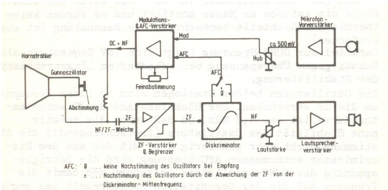
Abb.1: Blockschaema des X-Band-Transceivers von OE1RVW/OE1ABW
